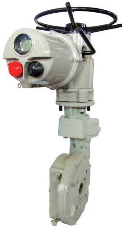
叠加（组合）式角行程电动执行机构 多回转电动执行机构+角行程齿轮箱 适用于扭矩超过2,000N.m 循环动作次数 ≥ 30000 次
